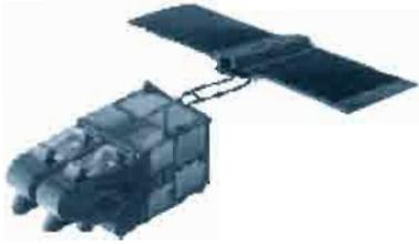
**Le satellite Spot** défile autour de la terre à une altitude moyenne de 830 km. Il permet l'enregistrement d'images de la terre dont la taille du point élémentaire (pixel) atteint 10 mètres.
