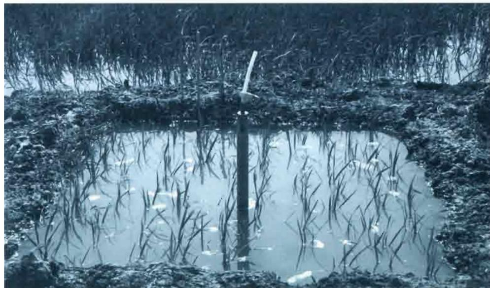
**Dispositif de mesure de l'évolution de la solution du sol (salinité, alcalinité)**
