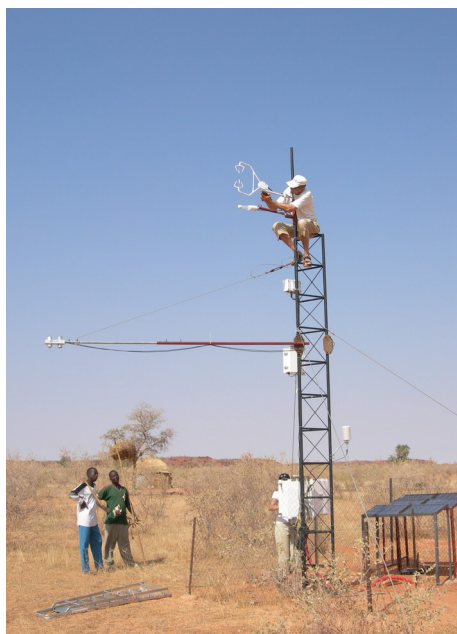
Figure 6 : Banizoumbou, Niger. Tour de mesure des flux turbulents dans un environnement sahélien, faisant partie des campagnes de terrain AMMA et de l'observatoire à long-terme AMMA-CATCH. Mai 2006. Photo : T. Lebel©IRD
