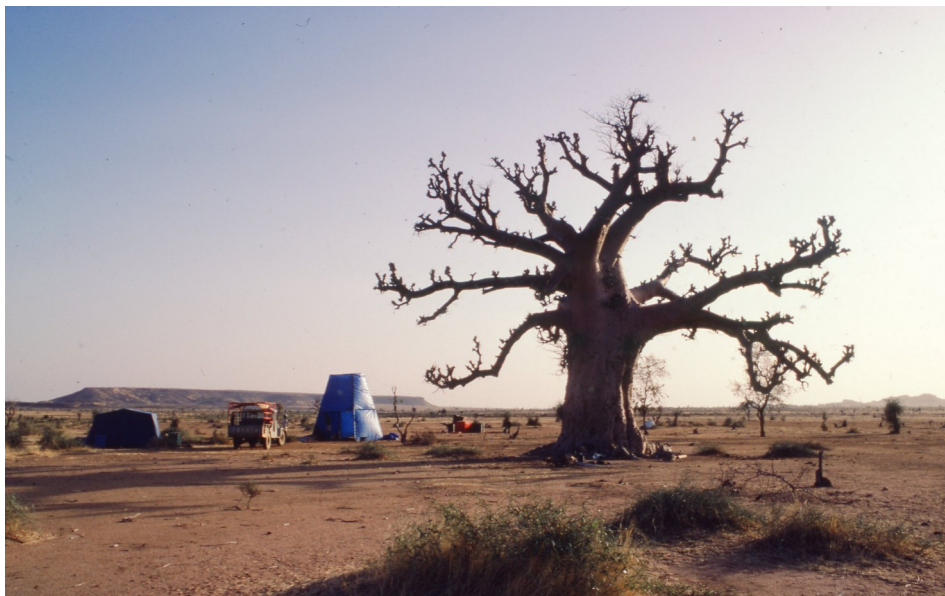
Figure 2 : Structure pyramidale d'un simulateur de pluie dans un environnement sahélien typique pendant la saison sèche - Mare d'Oursi, Burkina Faso. Les bâches bleues protègent la pluie simulée du vent fort. Mars 1981. Photo : P. Chevallier©IRD
